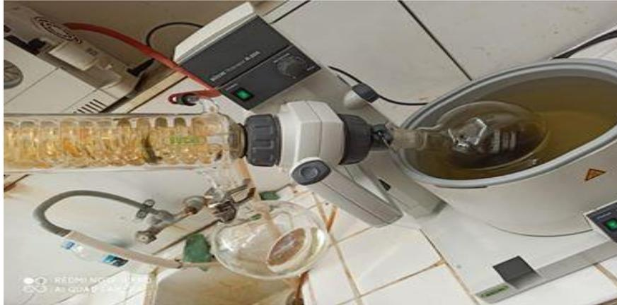
**Figure 22 :** Evaporateur rotatif.
